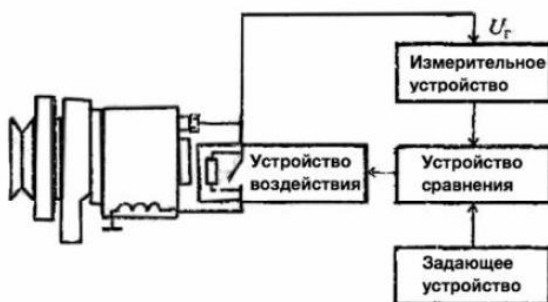
Рис. 29 – Структурная схема регулятора напряжения
