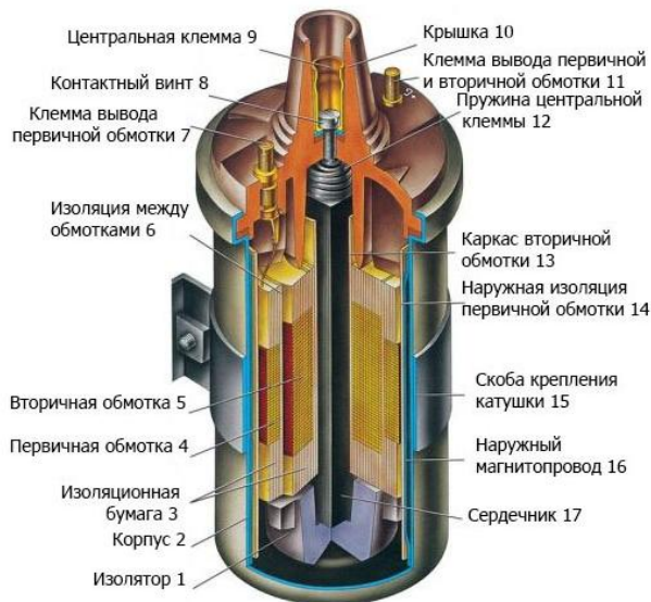
Рис.49 – Устройство катушки зажигания
