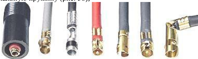
Рис. 58 – Различные типы наконечников высоковольтных проводов
