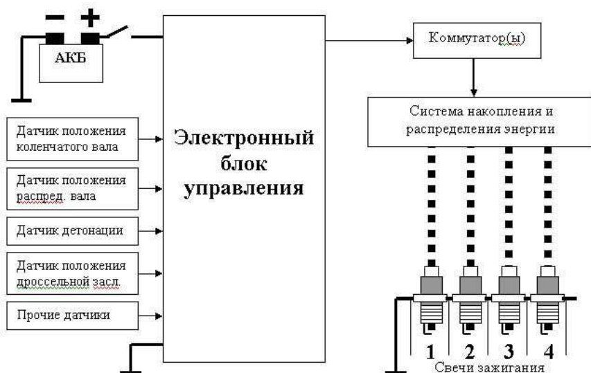
Рис. 66 – Общий вид микропроцессорной системы зажигания.
