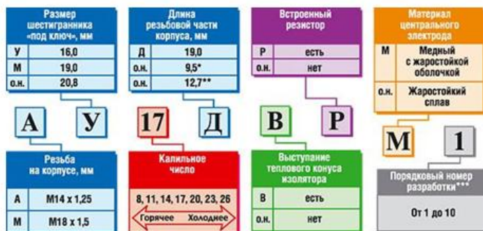
Рис. 51 – Условное обозначение российских искровых свечей зажигания
