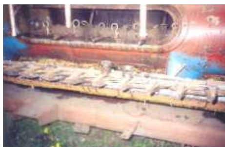
Рисунок 1 – Пальчиковый механизм шнека жатки в разобранном виде при проведении микрометража
