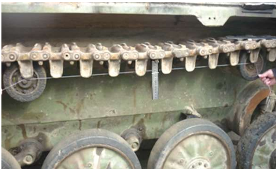
Рисунок 3 – Проверка натяжения по пробкам поддерживающих катков
