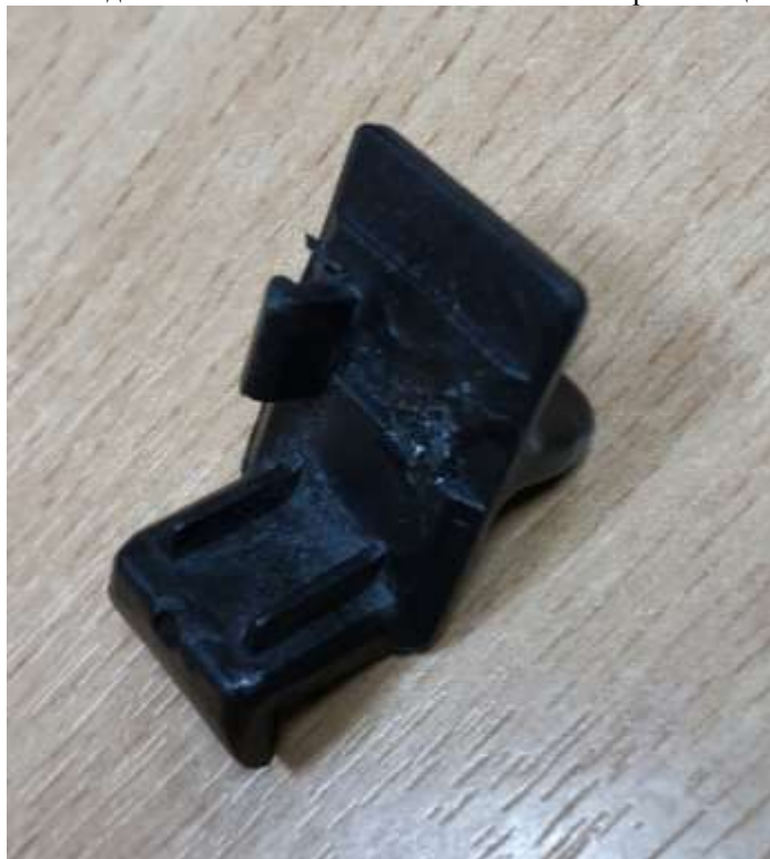
Рисунок 2 – Защелка-фиксатор с дефектом [Источник автора]
