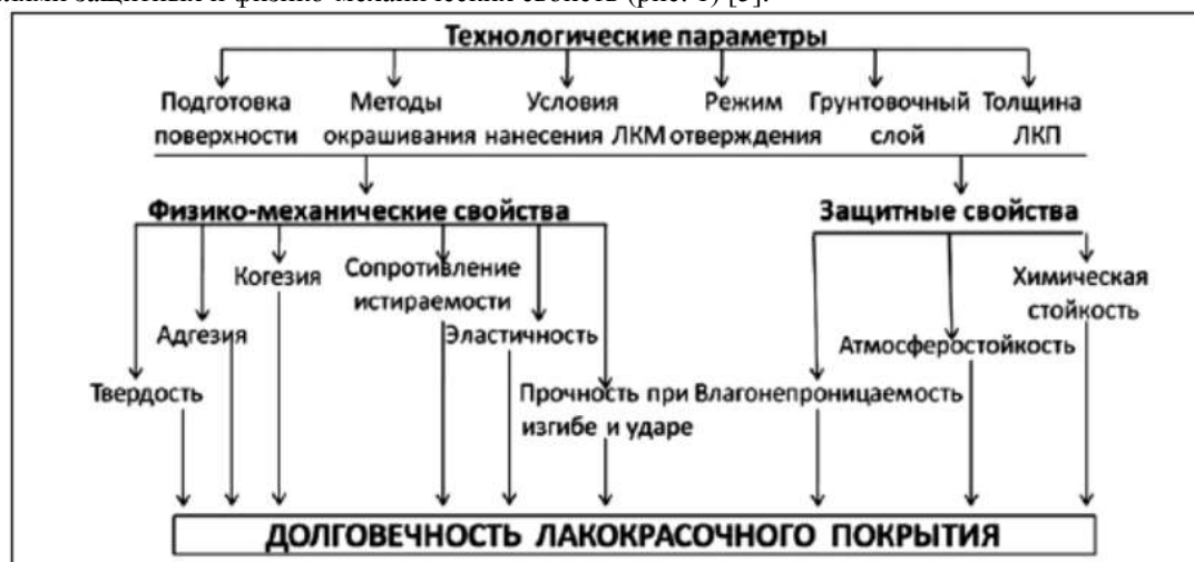
Рисунок 1. - Технологические параметры нанесения лакокрасочных материалов и свойства лакокрасочного покрытия, влияющие на долговечность
