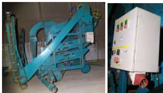
Рисунок 1 – Зерномет с силовым разъемом для подключения питающего кабеля: а – общий вид; б – щит управления с силовым разъемом
