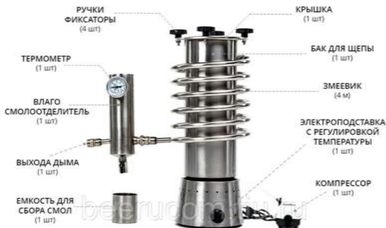
Рисунок 1 – Устройство дымогенератора
