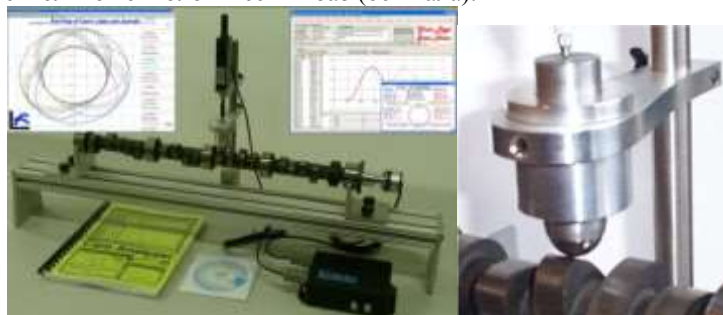
Рисунок 3 – Измерение кулачков распределительного вала
