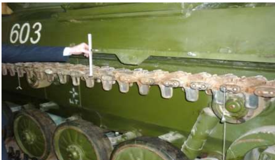
Рисунок 1 – Проверка натяжения используя нить, штыри и линейку
