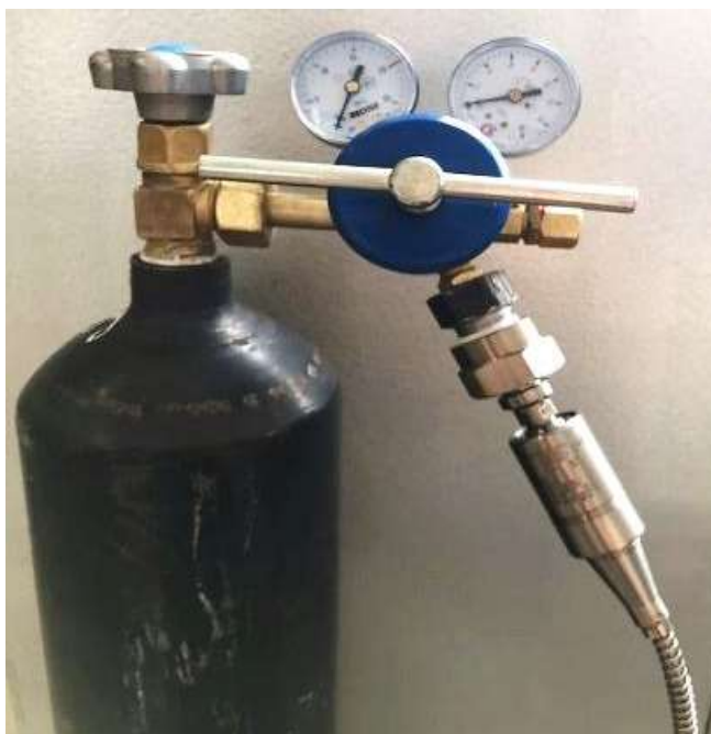
Рисунок 2 – Установка для проведения тарировки преобразователя давления
