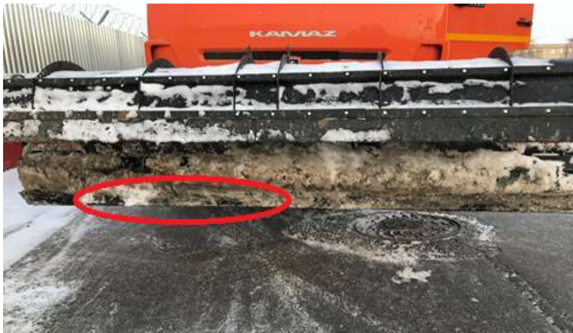
Рисунок 1. – Неравномерный износ ножа снегоотвала
