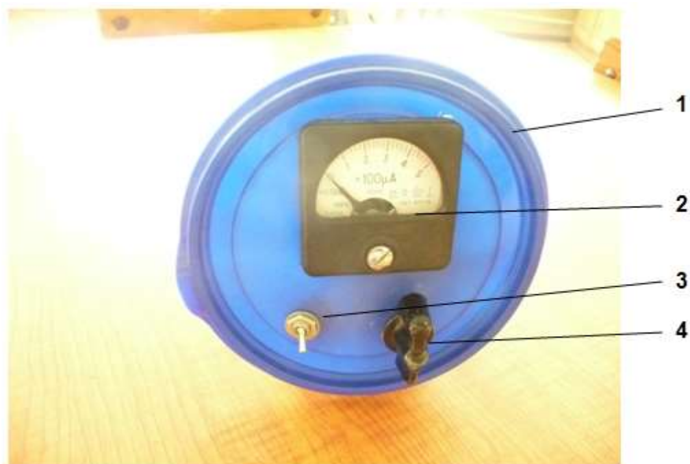
1 – корпус; 2 – миллиамперметр; 3 – выключатель питания; 4 – ручка потенциометра
