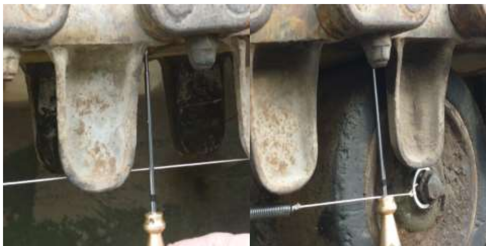
Рисунок 4 – Проверка натяжения используя нить с пружиной и телескопический стержень
