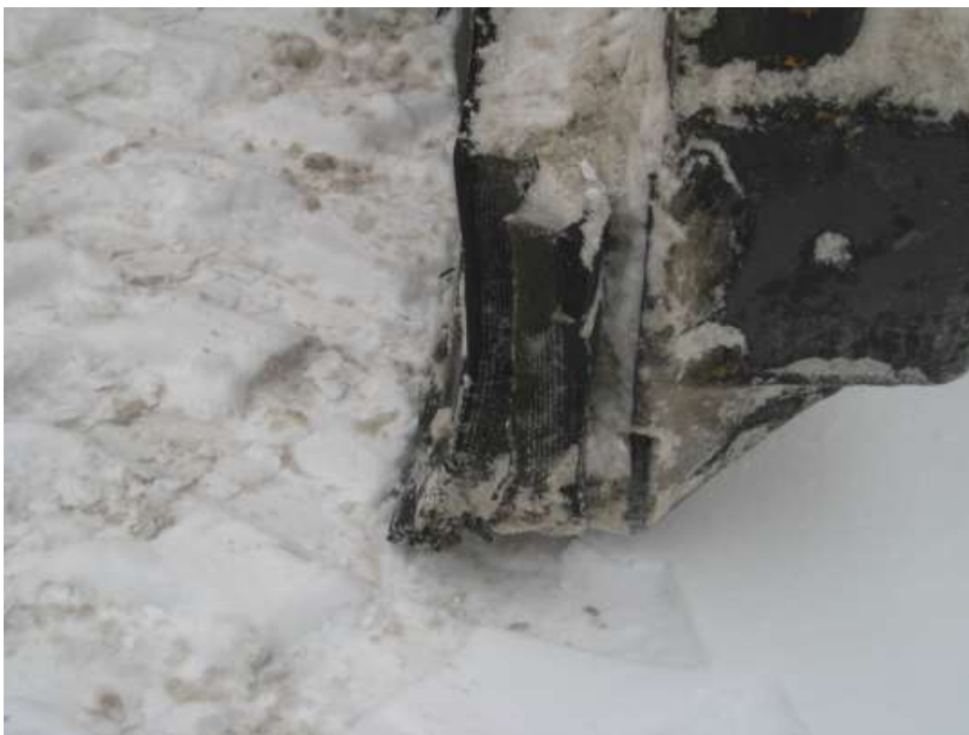
Рисунок 3.- Ступенчатая кромка ножа снегоотвала
