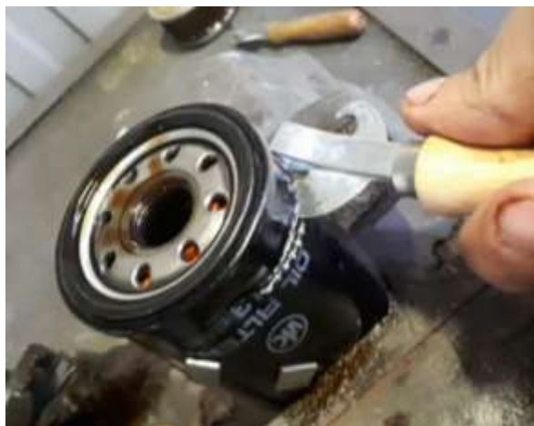
Рисунок 2 – Вскрытие масляного фильтра
