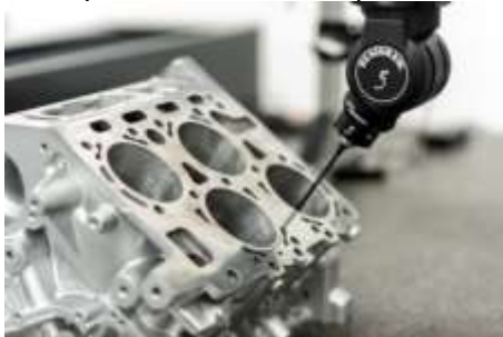
Рисунок 4 – Измерение мобильной контрольно-измерительной машиной
