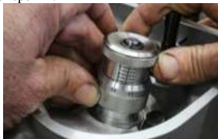
Рисунок 2 – Измерение установленной высоты на пружинах клапана микрометром высоты
