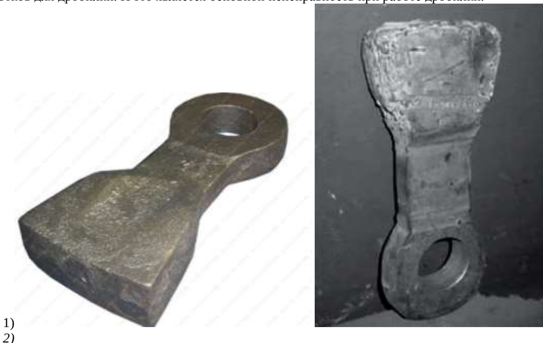
Рисунок 2 – Молотки дробилки: 1 – изношенные; 2 – новый
