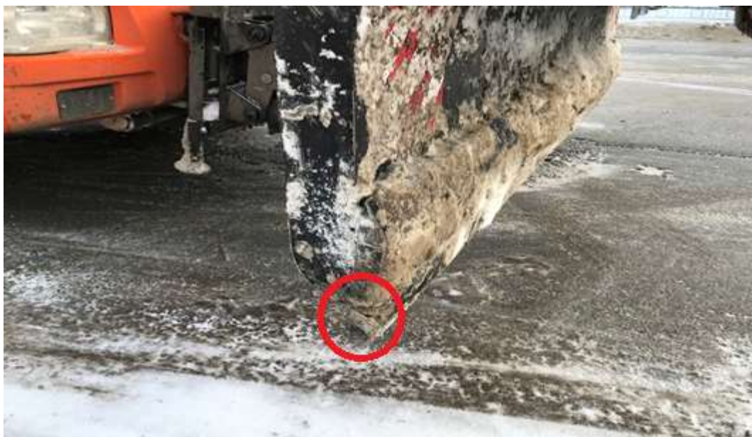
Рисунок 2. – Отрыв передней кромки ножа снегоотвала
