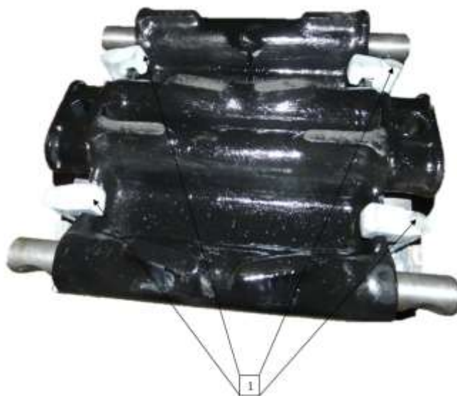
1 – крюки-зацепы со стяжными болтами
