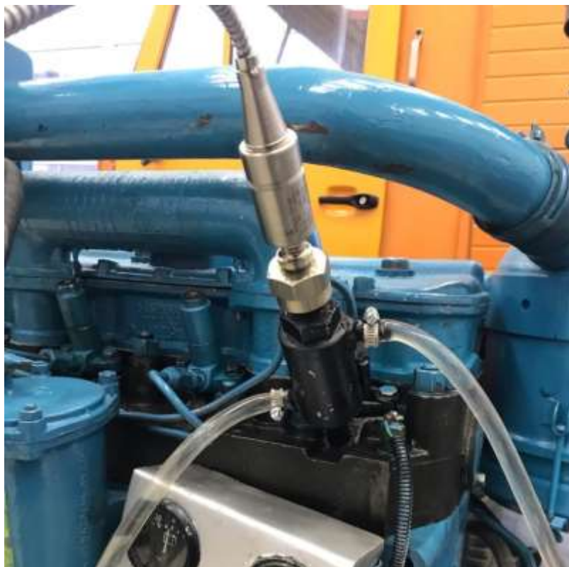
Рисунок 4 – Установка преобразователя давления на двигатель
