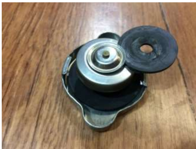
Рисунок 3. Пробка с демонтированной уплотнительной резинкой.
