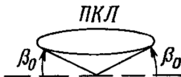
Рисунок 2 – Угол конусности лопастей
