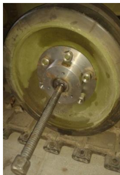
Рисунок 1 – Монтаж приспособление для демонтажа опорного катка БМП-3
