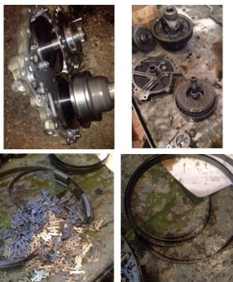
Рисунок 3 - Разрушение металлического ремня вариатора
