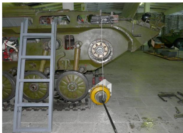
Рисунок 5 – Использование приспособления при демонтаже
