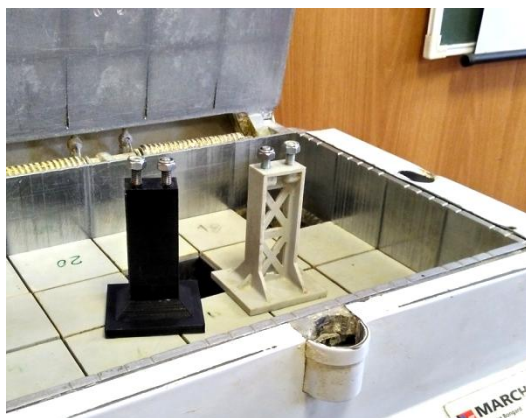
Рисунок 2- Выталкивающие детали тестodelительной машины (слева копия, справа оригинал)
