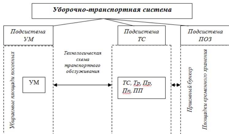
Схема 1 – Структура уборочно-транспортной системы
