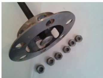
Рисунок 3 – Приспособление для демонтажа опорного катка БМП-3 в сборе
