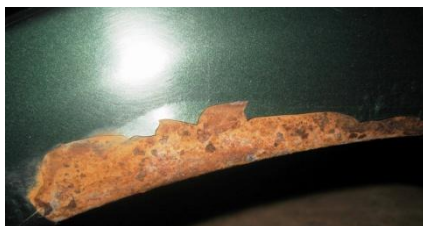
Рисунок 1 – Очаги коррозии на крыле автомобиля
