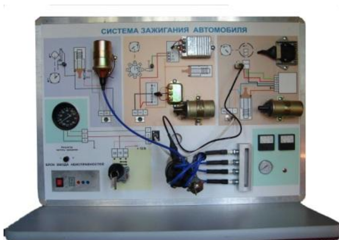
Рисунок - учебный стенд «Система зажигания автомобиля»
