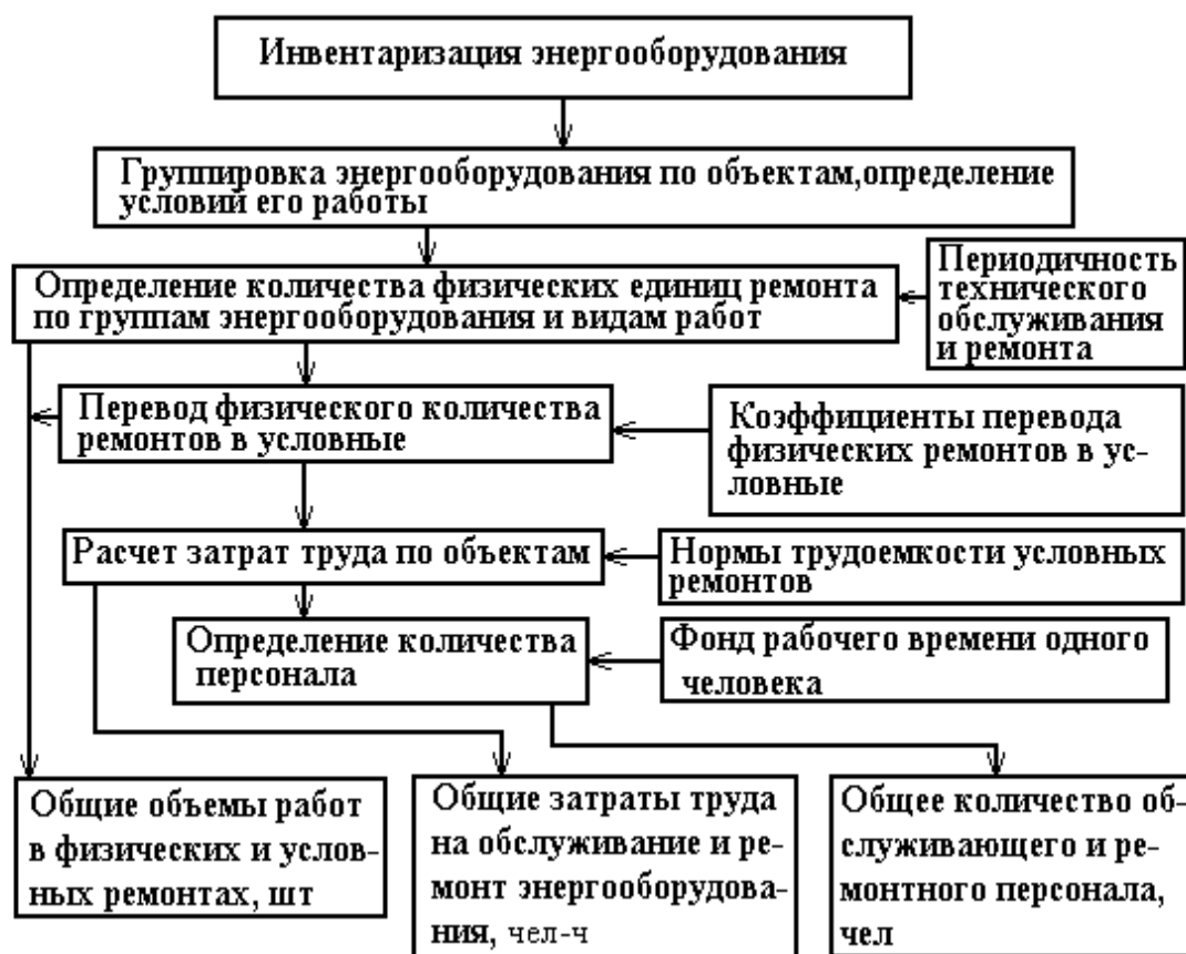
Рисунок 1 - Схема расчета объемов и стоимостей работ по обслуживанию и ремонту энергооборудования в хозяйстве
